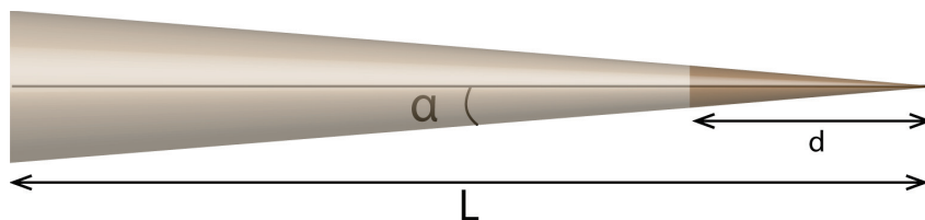
FIGURE 5.16 – Schéma d'un cône de longueur totale L et d'angle \alpha , avec une extrémité (ou un apex) de composition différente, de longueur d , utilisé comme modèle géométrique pour les nanopointes mesurées.
