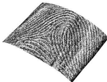
Figure 5.4 – Empreinte 3D OCT (représentation en intensité) du leurre A sur la surface de du doigt B.
