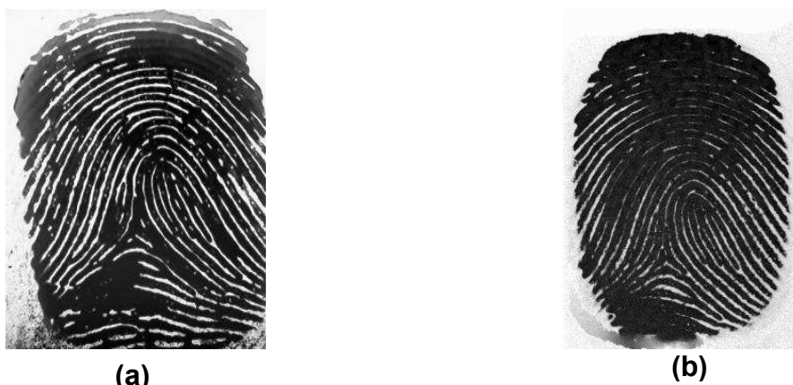
Figure 3.1 - Images d'empreinte digitale d'un doigt humide obtenue avec (a) un capteur optique avec contact et (b) un capteur capacitif avec contact.
