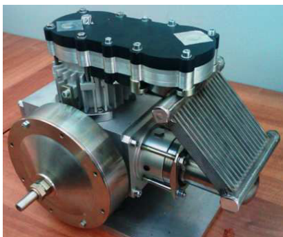
Fig. II.2 – Moteur Stirling mRT-1K (à gauche) et schéma de principe du prototype et du banc d'essai [CRE11].
