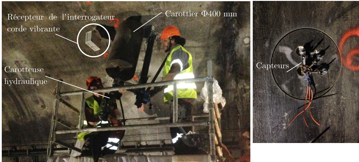
Figure 5.6 Carottage de 400 mm de diamètre et instrumentation pour l'essai
