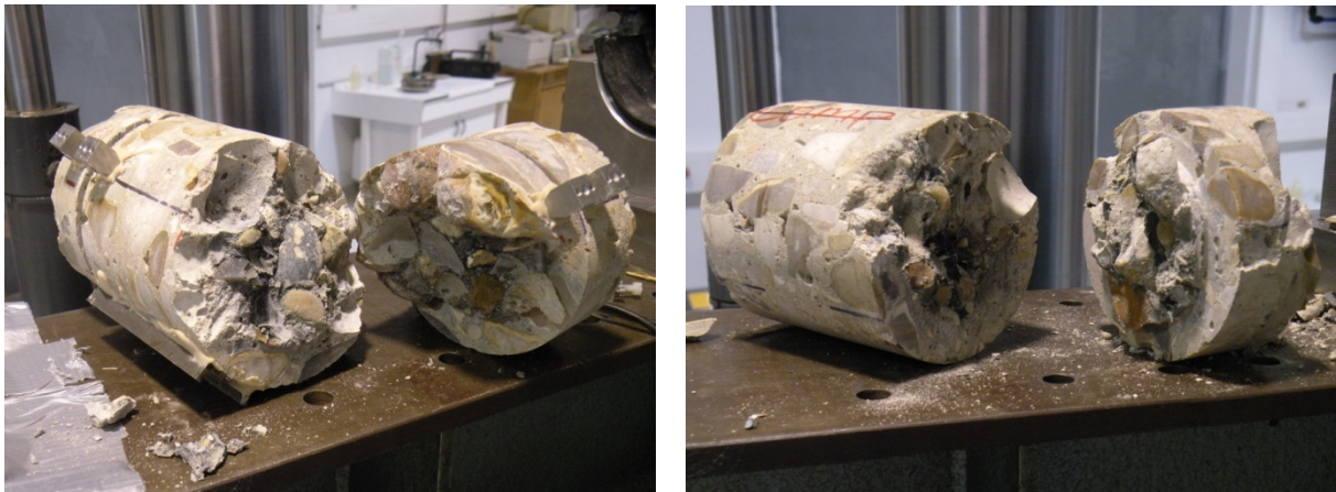
Figure 4.65 Mode de rupture observé dans les tests de cisaillement dans le béton
