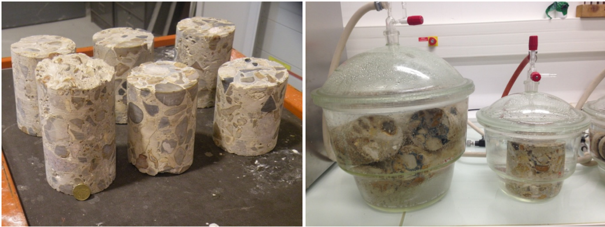
Figure 4.54 Épreuves (gauche) et appareillage (droite) pour le test de masse et porosité pour le béton
