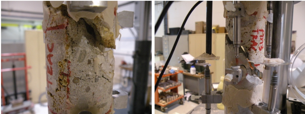
Figure 4.72 Rupture observée dans les tests de traction directe pour le composite
