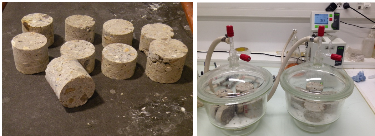
Figure 4.18 Éprouvettes (gauche) et appareillage (droite) pour l'essai de masse volumique et de porosité du mortier
