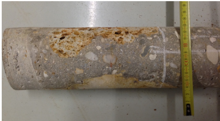
Figure 4.4 Maçonnerie de moellons retrouvée au niveau des piédroits dans l'interstation Anatole France – Pont de Levallois. Carotte de 103 mm de diamètre.
