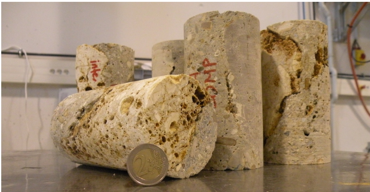
Figure 4.67 Éprouvettes de 73 mm pour l'essai de module et de compression sur le composite
