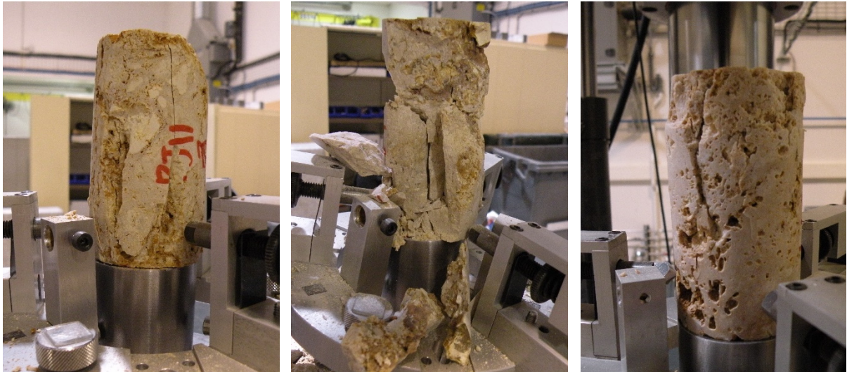
Figure 4.44 Rupture observée des éprouvettes de 50 mm de pierre en compression
