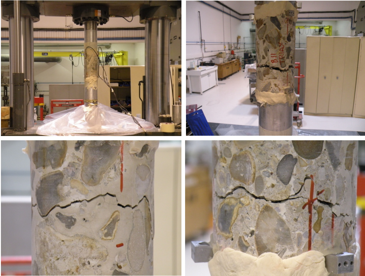
Figure 4.58 Dispositif (en haut à gauche) et fissuration dans les éprouvettes de béton en traction directe
