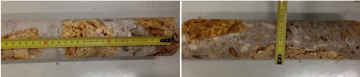
Figure 4.5 Carottes de maçonnerie de 73 mm de diamètre. Épaisseur des joints de mortier dans la maçonnerie allant de 2,5 cm à 10 cm
