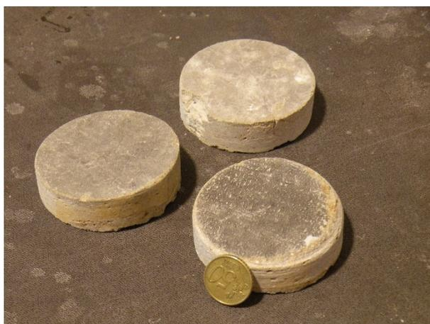
Figure 4.19 Éprouvettes de mortier d'enduit
