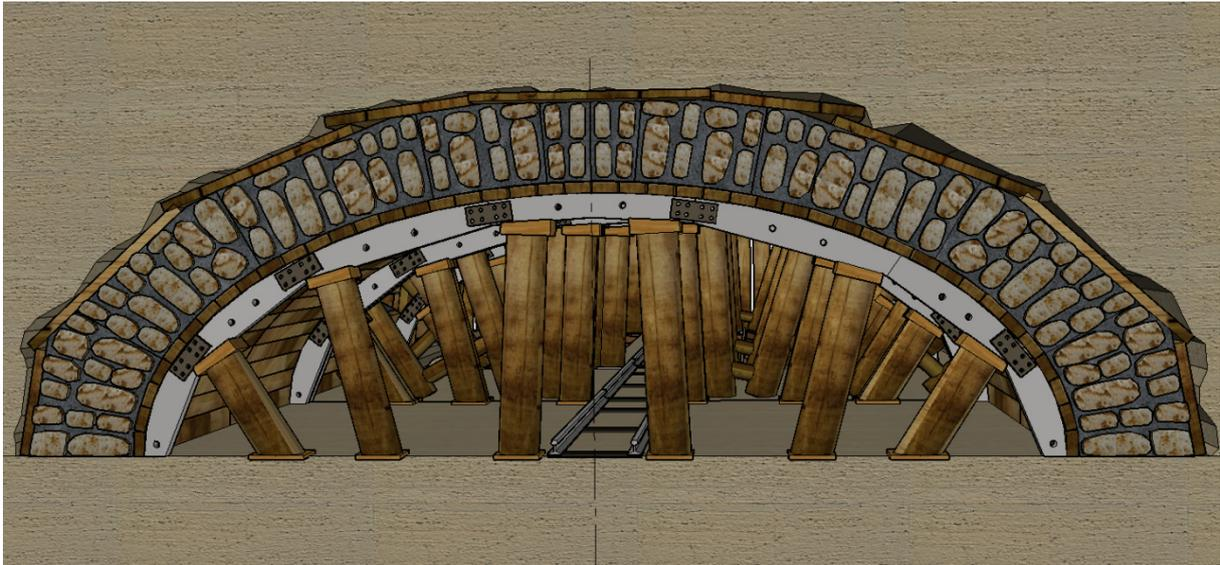
Figure 1.16 Quatrième phase – Maçonnerie de la voûte achevée
