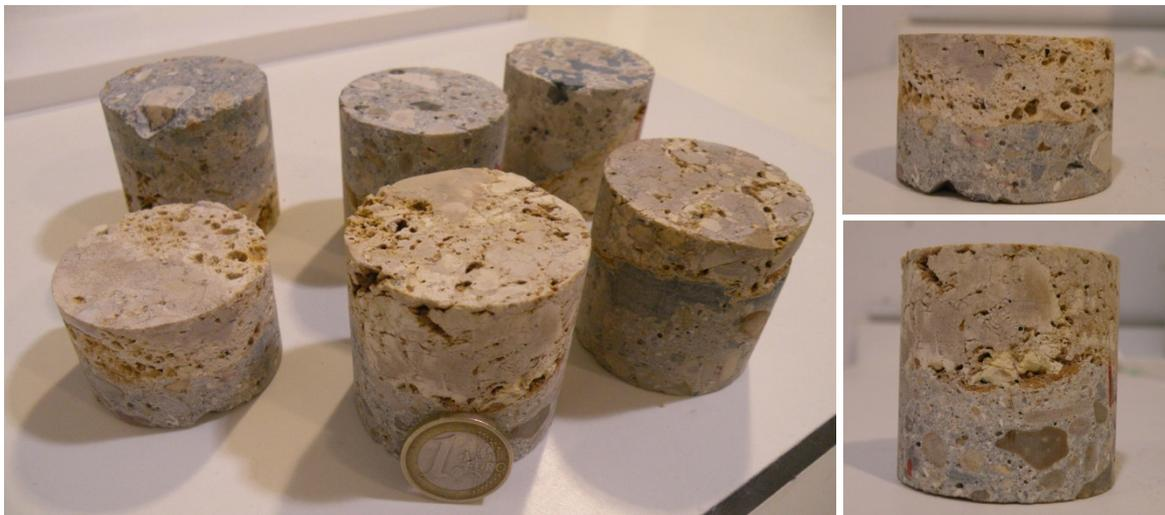
Figure 4.74 Éprouvettes de composite pour le test en traction directe sur l'interface
