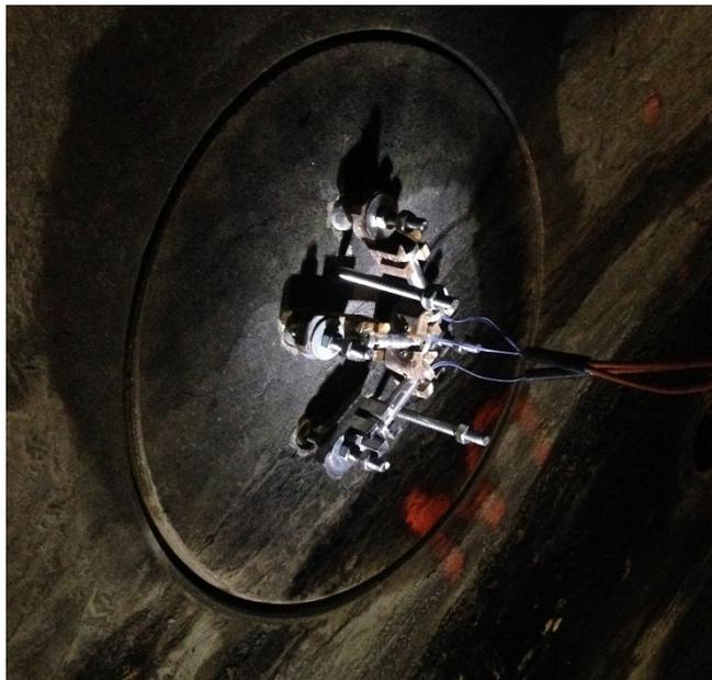
Figure A4.1 Mesure de déformations d'un élément cylindrique relâché
