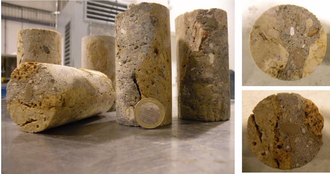
Figure 4.71 Éprouvettes de composite pierre-mortier de 50 mm pour le test en traction directe
