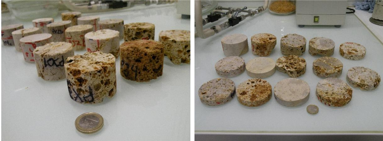
Figure 4.37 Éprouvettes pour l'essai de masse volumique et de porosité de la pierre
