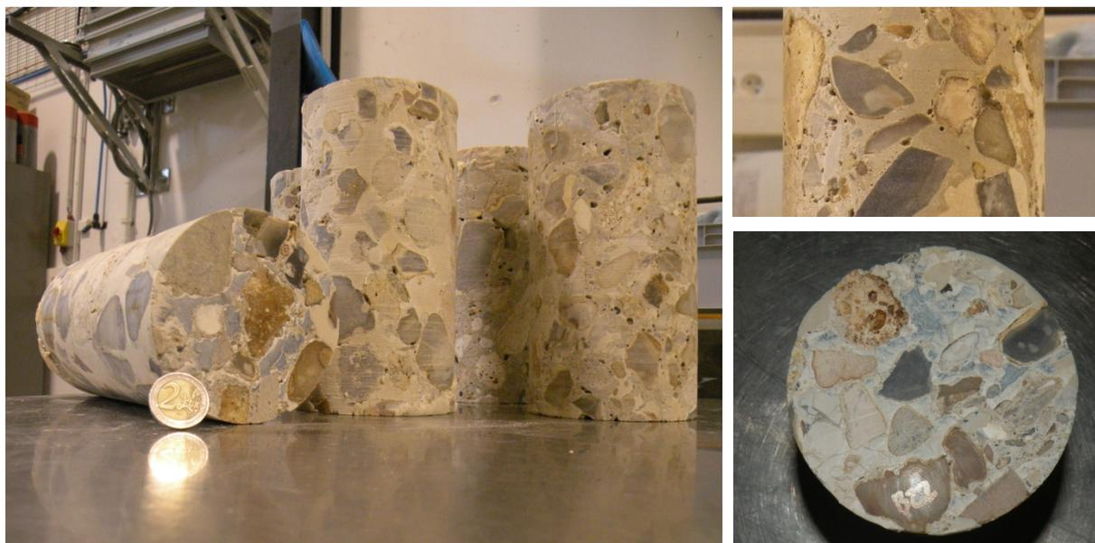
Figure 4.53 Éprouvettes de béton de 100 mm de diamètre et 200 mm de hauteur
