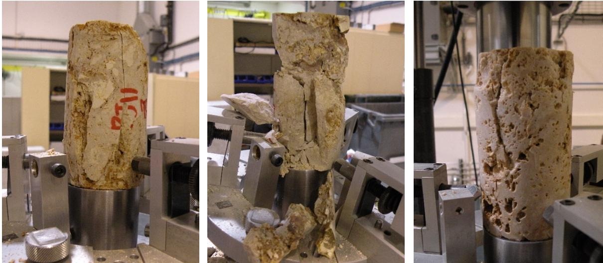
Figure 4.44 Rupture observée des éprouvettes de 50 mm de pierre en compression
