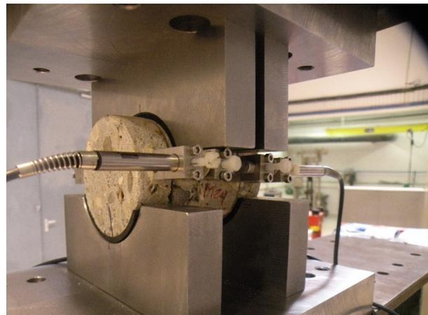
b) Capteurs d'ouverture de l'entaille
