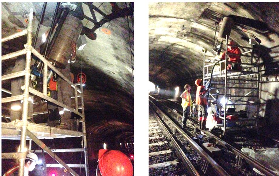
Figure 5.7 Exécution de l'essai de mesure de contraintes
