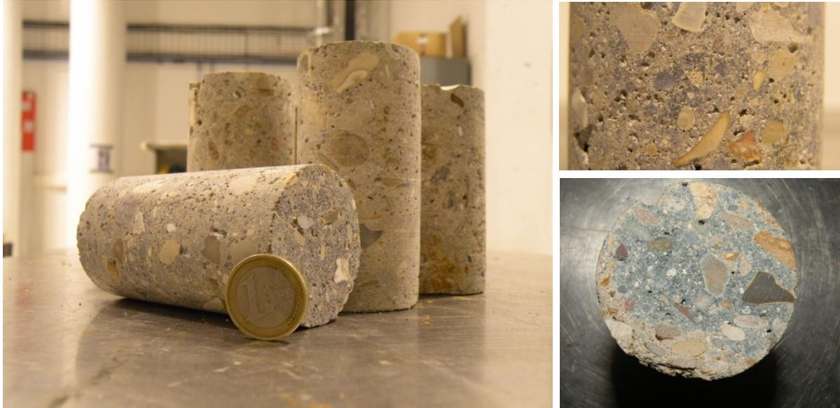
Figure 4.17 Éprouvettes de mortier de 50 mm de diamètre et 100 mm de hauteur
