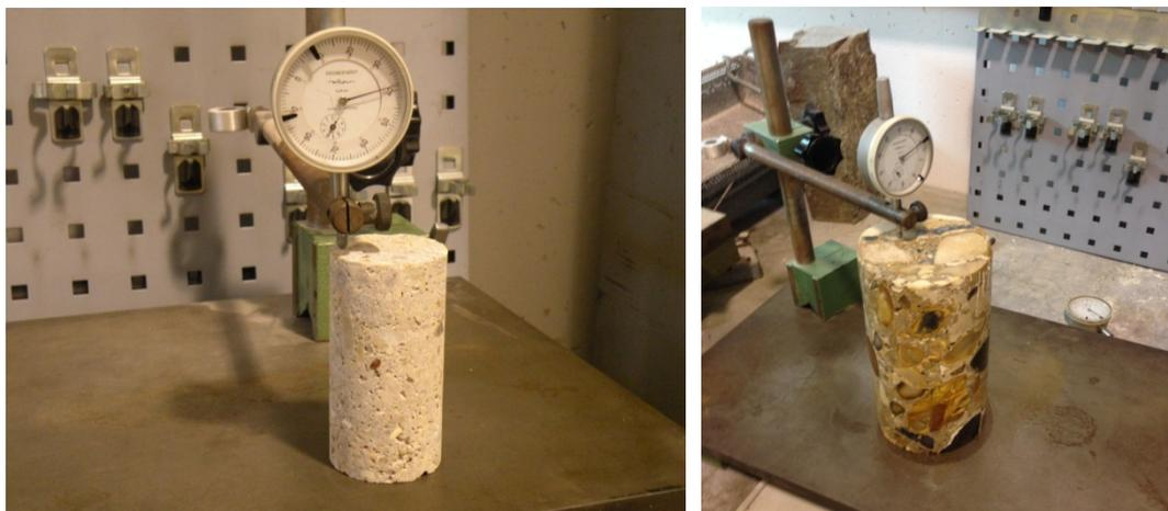
Figure 4.12 Vérification de la planéité des éprouvettes de 50 et 100 mm de diamètre
