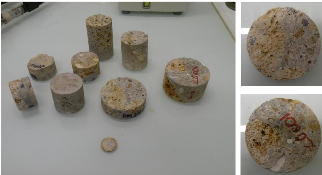
Figure 4.66 Éprouvettes pour le test de masse et de porosité sur le composite
