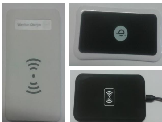
Figure 3.15 : Stations pour la recharge sans fil Qi.
