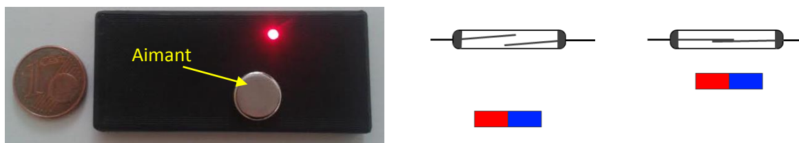
Figure 5.21 : Activation du patch avec un aimant externe.
