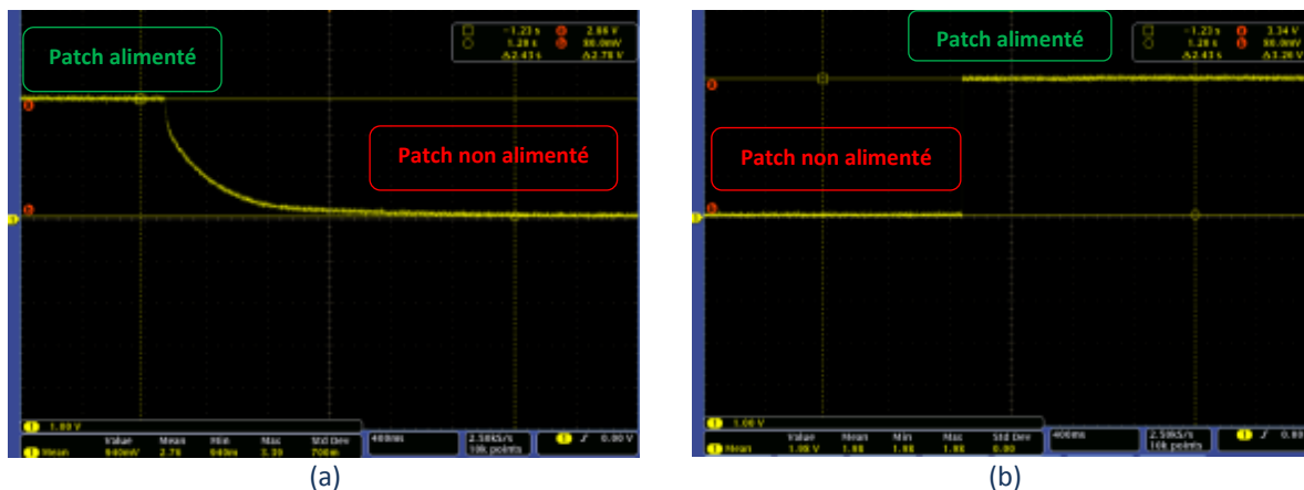
Figure 5.22 : Fonctionnement de la protection « undervoltage » (a : Coupure à V_{bat}=2,86V et b : activation à V_{bat}=3,34V ).
