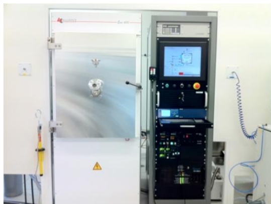
Figure 4.15 : Machine EVA 600 pour le dépôt par évaporation disponible en salle blanche du LAAS-CNRS.
