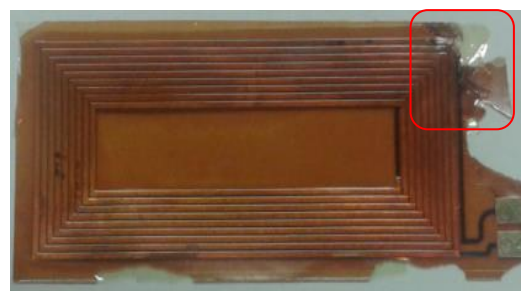
Figure 4.36 : Décollement d'une zone de cuivre.
