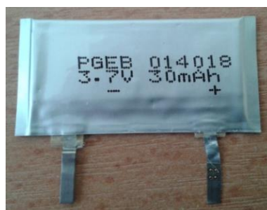
Figure 3.1 : Batterie LiPo utilisée dans le patch.
