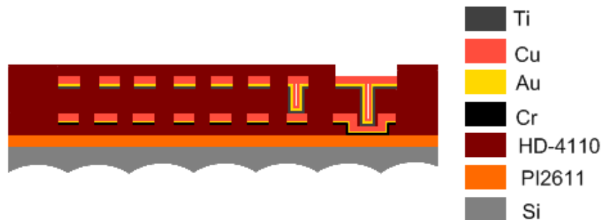
Figure 4.33 : Dépôt du deuxième cover layer.
