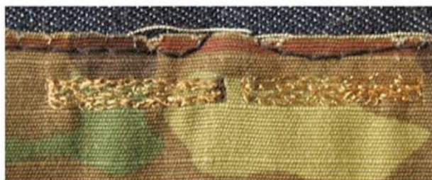
Figure 1.10 : Antenne réalisée avec des fils de cuivre © [2014] IEEE [39].
