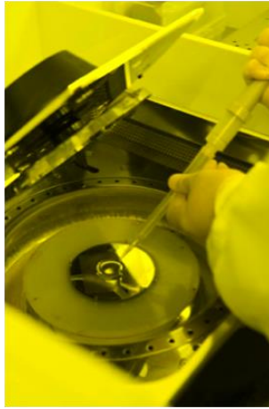
Figure 4.9 : Dépôt de la résine par enduction.
