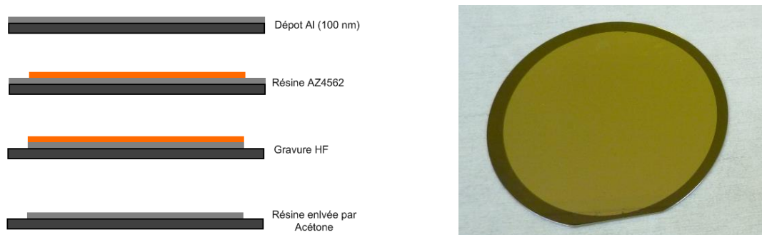
Figure 4.48 : Dépôt de la couche d'aluminium.
