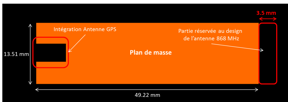
Figure 2.28 : Contraintes d'intégration de l'antenne ISM 868 MHz.
