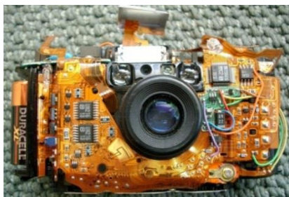
Figure 4.1 : Exemple d'un circuit souple utilisé dans un appareil photo Olympus Stylus (Steve Jurvetson, Menlo Park, USA- CC BY 2.0 ).
