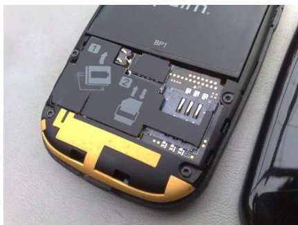
Figure 2.17 : Exemple d'une antenne IFA utilisée dans un téléphone PALM (Abul Hussain-CC BY 2.0).
