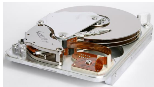
Figure 4.2 : Vue interne d'un disque dur Seagate (Eric Gaba – CC-BY-SA 3.0).
