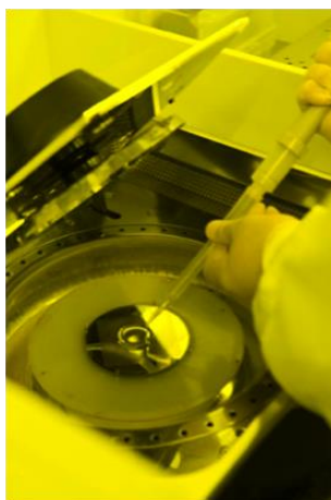
Figure 4.9 : Dépôt de la résine par enduction.
