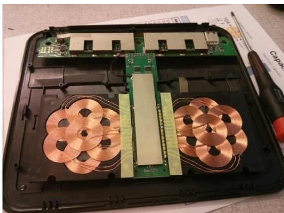
Figure 3.4 : Chargeur de smartphone et tablette compatible avec le protocole Qi (Peter Burka - CC BY-SA 2.0).
