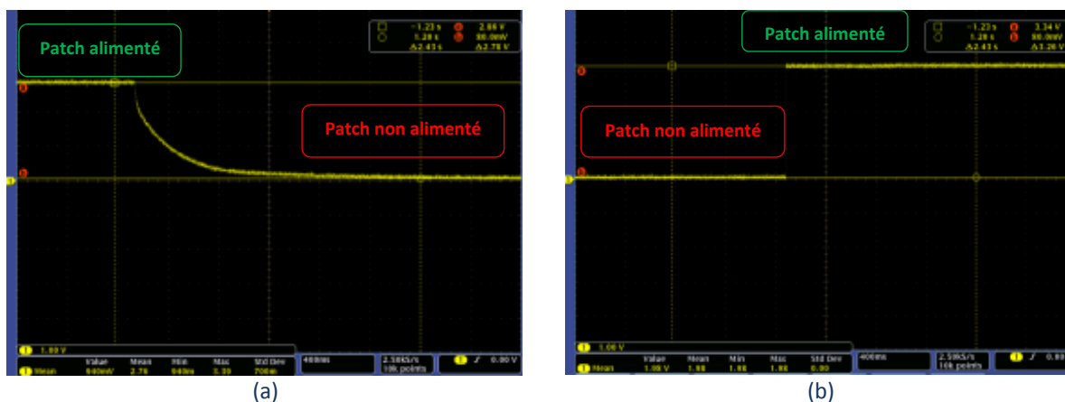
Figure 5.22 : Fonctionnement de la protection « undervoltage » (a : Coupure à V_{bat}=2,86V et b : activation à V_{bat}=3,34V ).
