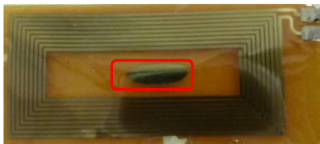
Figure 4.25 : Partie de cuivre restante après la gravure chimique.
