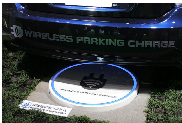
Figure 3.5 : Recharge sans fil d'un véhicule électrique (Njo-CC BY-SA 3.0).
