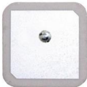
Figure 2.41 : Antenne GPS ADA-25252 [22] de type patch, polarisation circulaire droite (RHCP) qui caractérise les ondes émises par les satellites pour minimiser ainsi les pertes dues à la désadaptation de polarisation.
