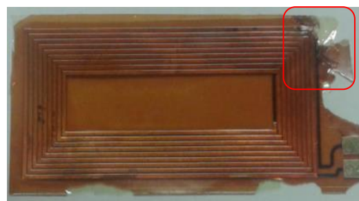
Figure 4.36 : Décollement d'une zone de cuivre.
