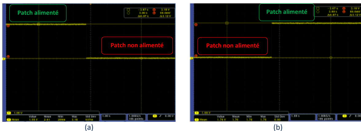
Figure 5.23 : Tension à la sortie du régulateur (a : coupure avec la présence du chargeur sans fil et b : Réactivation en fin de charge).
