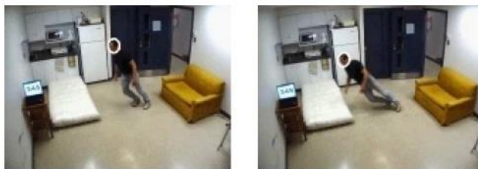
Figure 1.7 : Exemple de détection de chute en calculant la vitesse de la tête © [2006] IEEE [24].
