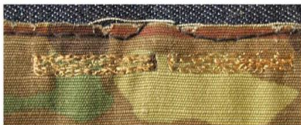
Figure 1.10 : Antenne réalisée avec des fils de cuivre © [2014] IEEE [39].
