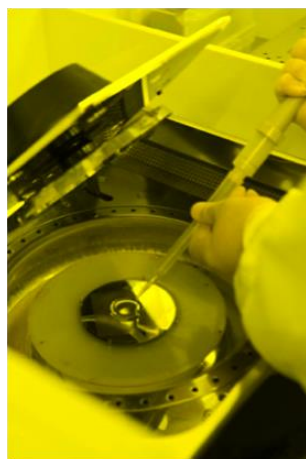
Figure 4.9 : Dépôt de la résine par enduction.
