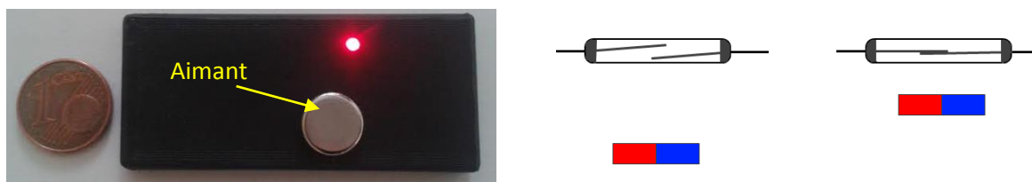
Figure 5.21 : Activation du patch avec un aimant externe.
