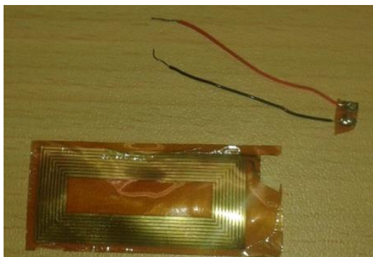
Figure 4.35 : Décollement des connexions métalliques et polyimide.
