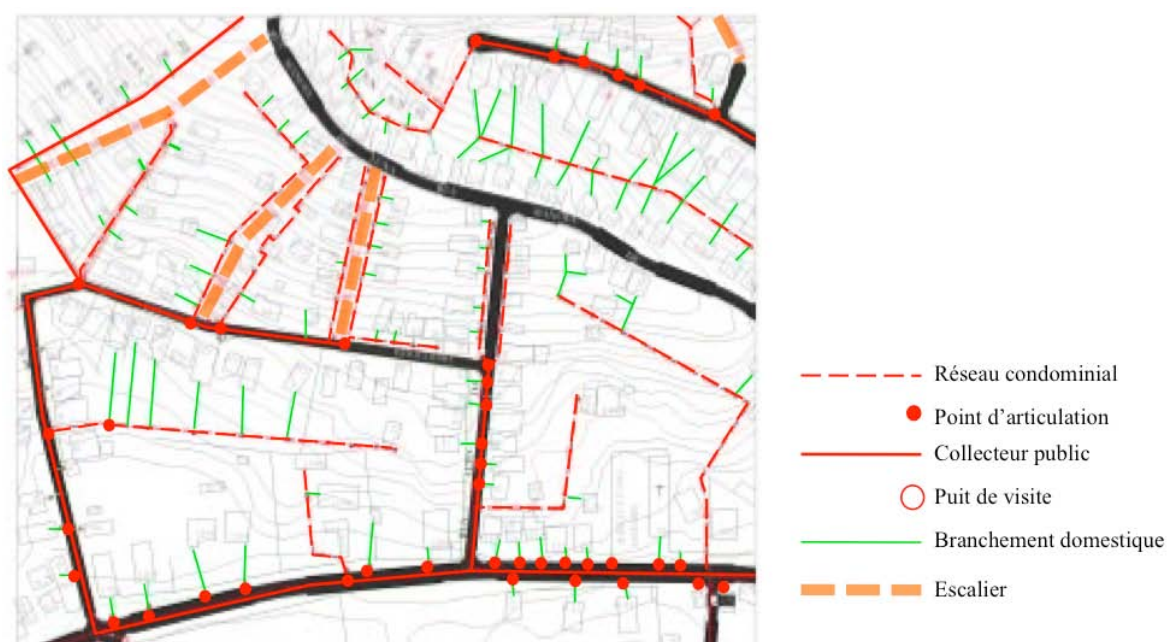
Figure 3-34 : Schéma d'installation de systèmes d'assainissement condominial
