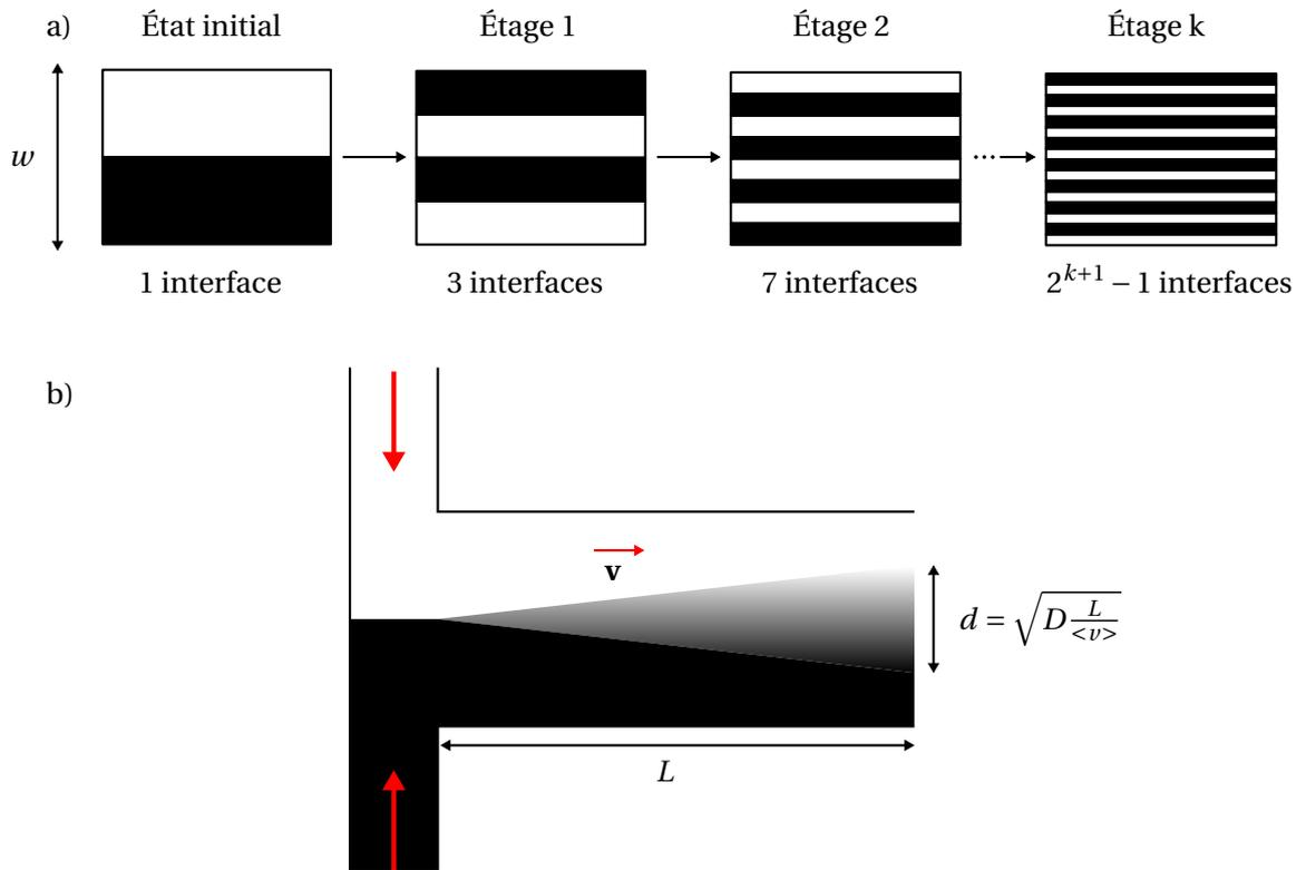
FIGURE 2.1 – Principe de la transformation du boulanger et de la diffusion dans un microcanal. a) Séparation et combinaison de flux pour obtenir  $2^{k+1} - 1$  interfaces (ou fronts de diffusion) au  $k$ -ième étage du mélangeur. b) Diffusion de deux espèces introduites dans un canal sur une distance  $L$ , où  $\langle v \rangle$  est la vitesse moyenne de l'écoulement.  $d$  est la distance caractéristique de diffusion et dépend du coefficient de diffusion  $D$ .
