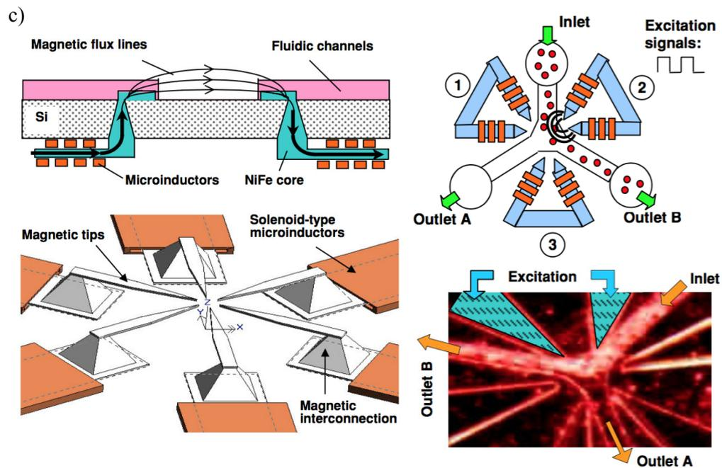
FIGURE 1.24 – Micro-bobines. a) Différents designs de bobines, avec double-bobines et plots magnétiques (noyau de la bobine) [167]. b) Schéma de fabrication pour une matrice de bobines spirales planaires et microcanaux [171]. c) Micro-électroaimants et circuits magnétiques permettant l'attraction de billes magnétiques [172].
