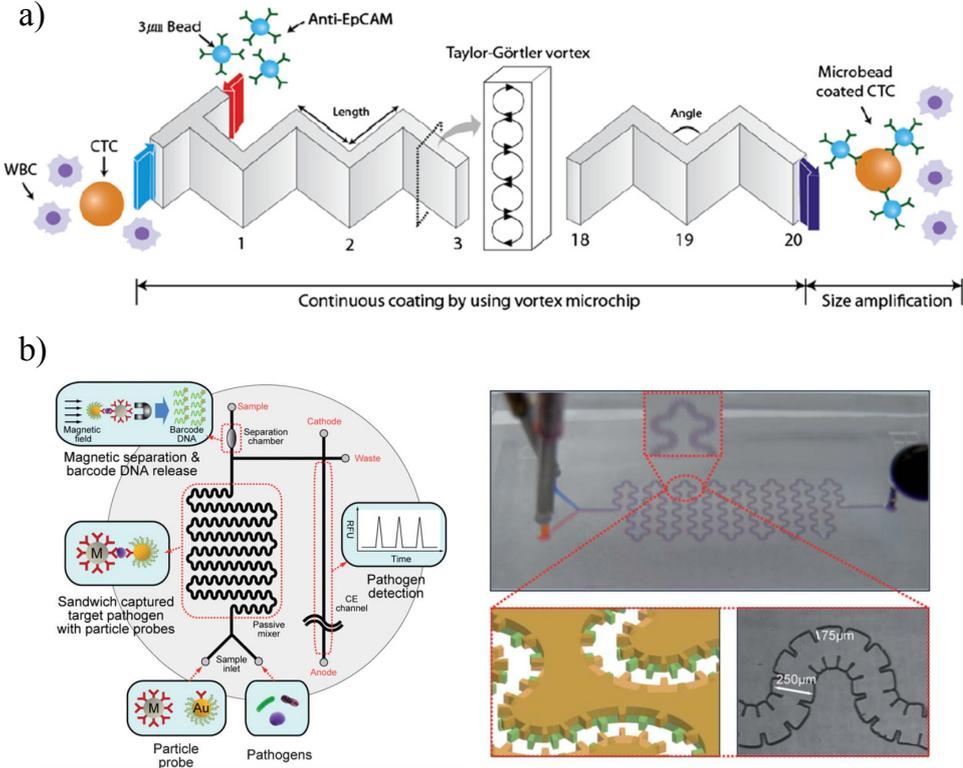
FIGURE 1.6 – a) Dispositif de mélange utilisant des vortex de Taylor-Görtler [51]. b) Système de détection de pathogène utilisant un étage de mélange intégré à base de serpentins structurés en forme d'intestin [52].
