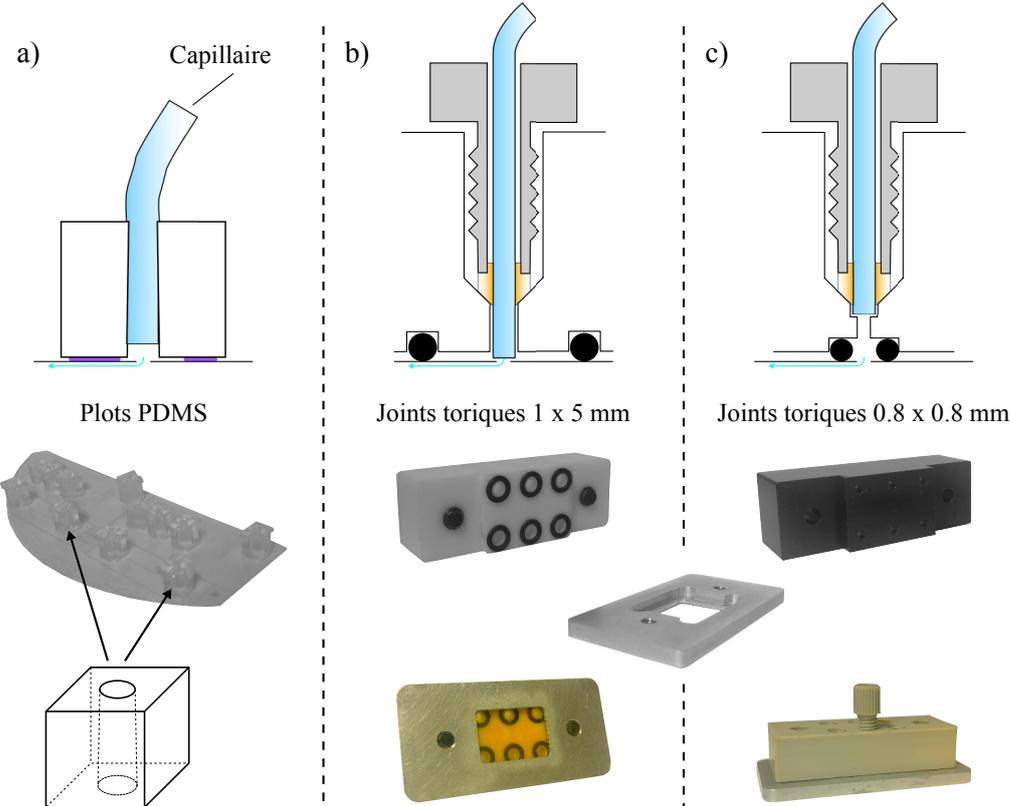
FIGURE 2.30 – Connectiques utilisées pour l'interface fluide des puces. a) Plots en PDMS. b) Premier design de support de puce. c) Deuxième design de support de puce.
