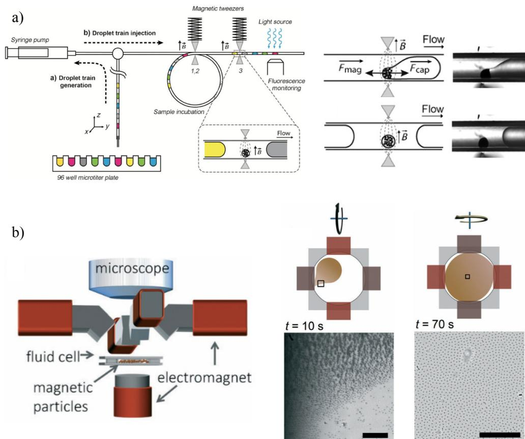
FIGURE 1.25 – Bobines externes. a) Dispositif de pinces magnétiques autour d'un capillaire permettant l'extraction de micro-billes magnétiques d'une goutte et leur réinjection dans une goutte suivante [176]. b) Set-up expérimental pour l'étude de la rotaphorèse interfaciale et dispersion d'un liquide contenant un grand nombre de particules [180].
