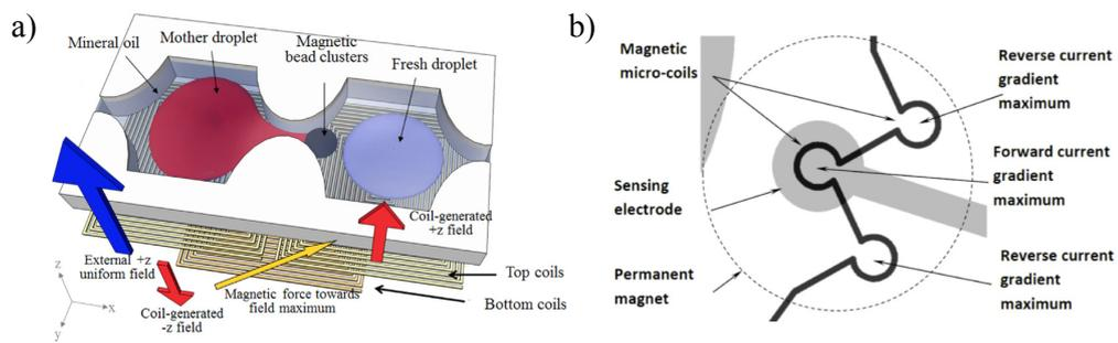
FIGURE 1.22 – Systèmes hybrides : aimants externes et micro-bobines. a) Deux niveaux de micro-bobines spirales planaires baignant dans un champ magnétique homogène vertical pour l'actionnement et le déplacement de billes magnétiques en gouttes [154]. b) Micro-bobines filaires dans un champ magnétique homogène pour l'attraction et répulsion de billes marquées en vue de leur détection [157].
