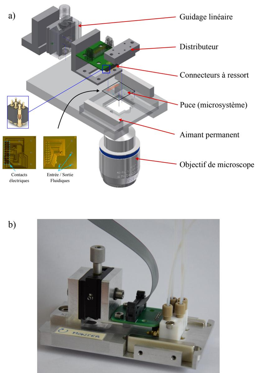
FIGURE 3.19 – Support de puce pour le dispositif magnétofluidique. a) Schéma éclaté du support. b) Photographie du support une fois assemblé.
