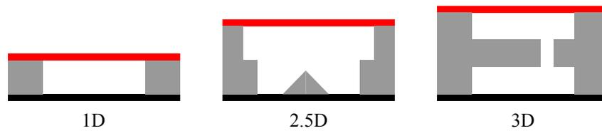
FIGURE 1.10 – Schéma de la terminologie employée pour les structures 2, 2.5D et 3D. Les couches noires et rouges représentent un substrat et un capot, respectivement. À noter : des géométries plus complexes (arcs de cercles, capillaires. . .) existent pour les structures 2.5D et 3D.
