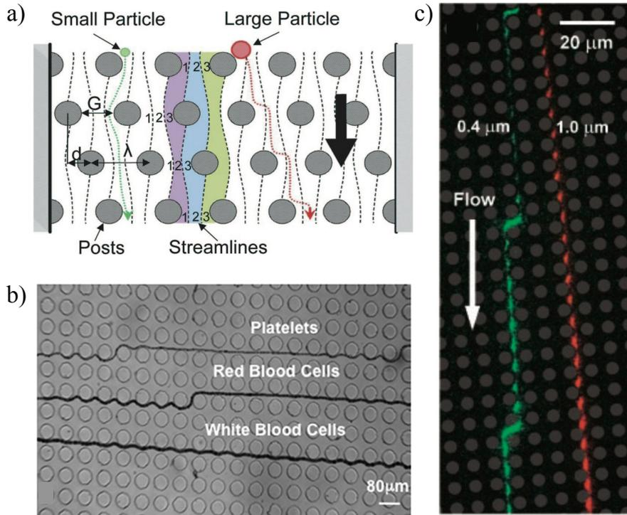
FIGURE 1.4 – Séparation par DLD. a) Principe (schema dans Davis *et al.* [32]. b) Exemple d'application pour la séparation du sang [33]. c) Article original de Huang *et al.* sur le tri de particules sub-micrométriques. [30]
