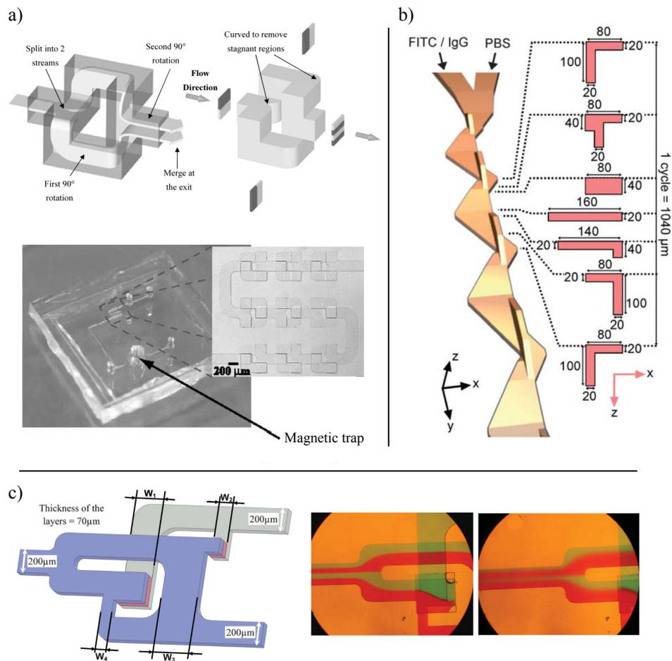
FIGURE 1.8 – Dispositifs de mélange par laminage en PDMS. a) Tan *et al.* proposent une suite de mélangeurs basés sur la transformation du boulanger [53]. b) Dispositif à un seul niveau, en PDMS, de Yasui *et al.* [56]. c) Mélangeur (un seul étage) à 3 niveaux de PDMS, étudié par Sadabadi *et al.* Les images de microscopie représentent les flux pour  $400 \mu\text{L min}^{-1}$  (gauche) et  $40 \mu\text{L min}^{-1}$  (droite) [55].
