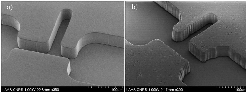
FIGURE 2.21 – Différences entre masques dur et souple pour les étapes de photolithographie. Couches de TMMF de  $45\ \mu\text{m}$ , intersection pour un dispositif de type bypass (design 2, premier niveau), obtenues avec a) un masque dur et b) un masque souple.
