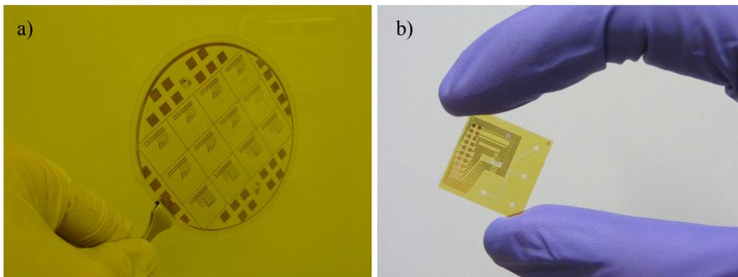
FIGURE 3.18 – Dispositifs obtenus après fabrication, combinant verre (substrat), résine et films époxy, et pistes métalliques (or). a) Wafer entier (4"). b) Puce individuelle (tableau de pièges magnétiques), 18 mm.
