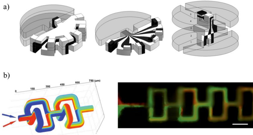
FIGURE 1.9 – Technologies de fabrication moins conventionnelles pour le micromélange. a) Dispositif réalisé par usinage (Neerinx *et al.*) [57]. b) Microsystème de Liao *et al.* obtenu par écriture laser directe [58].
