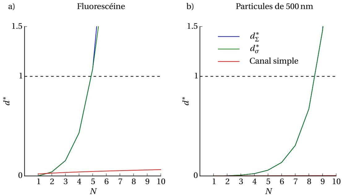
FIGURE 2.3 – Tracés des distances caractéristiques de diffusion adimensionnalisées (par  $w$ ) pour le mélangeur 3D proposé pour a) de la fluorescéine et b) des particules de 500 nm. Le cas du canal simple correspond à la diffusion d'un seul front de diffusion pris le long de la géométrie 3D. La légende est commune aux deux graphes, les courbes bleue et verte sont superposées sur b).
