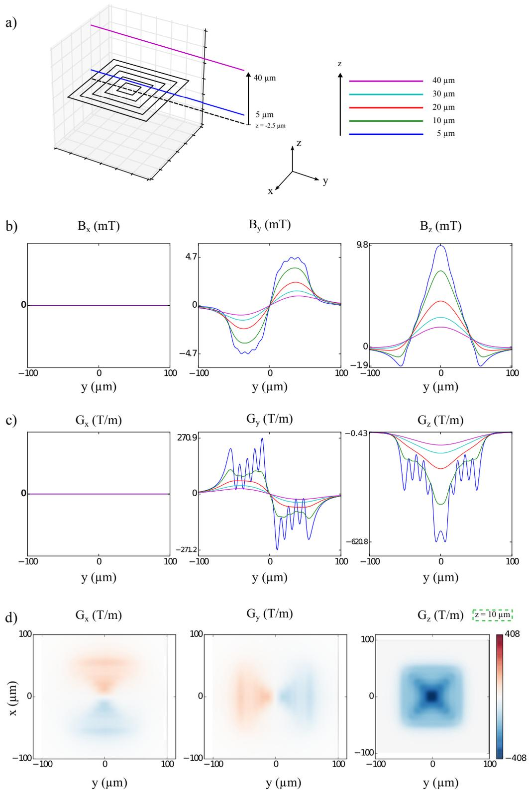
FIGURE 3.3 – Résultats de calculs analytiques pour un modèle de bobine spirale rectangulaire à 5 tours, avec  $I = 100 \text{ mA}$ . a) Géométrie de la bobine et représentation de l'altitude pour les tracés suivant. c-d) Tracés de  $B$  et  $G$  à différentes altitudes (5, 10, 20, 30 et 40  $\mu\text{m}$  du haut de la bobine, avec une épaisseur supposée à 5  $\mu\text{m}$ ). e) Représentation en 2D (plan  $z = 10 \mu\text{m}$ ) de  $G$ .
