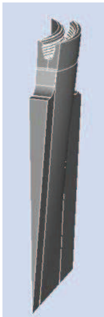
FIGURE 6 – Modèle CAO de l'attache de l'ailette.
