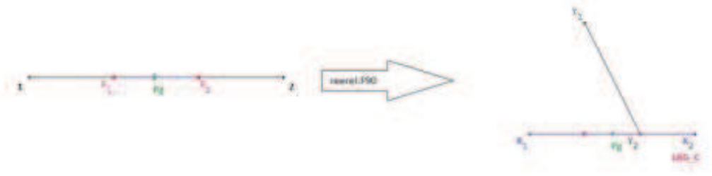
FIGURE 4.23 – Point de Gauss, Pg , dans l'espace réel de la maille de contact.
