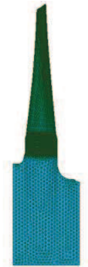
FIGURE 6.32 – Maillage fin du modèle ailette + attache.
