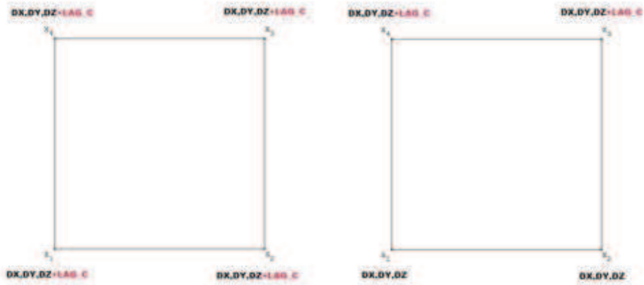
FIGURE 4.8 – Attribution des degrés de liberté sur les nouvelles mailles de contact esclave QUAD 4 (type E5 à gauche et types E1, E2, E3 et E4 à droite).
