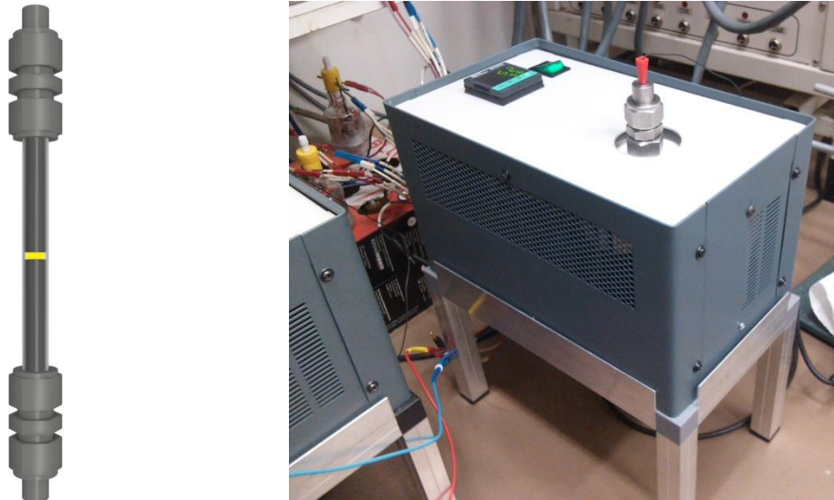
Figure III.32. Schéma de la cellule utilisée pour le cyclage en température et photo du four dans lequel elle est introduite.
