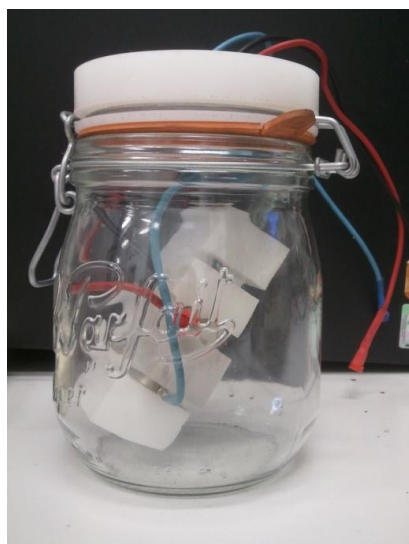
Figure A.9. Photo de la cellule de conductivité et de cyclage galvanostatique utilisée.
