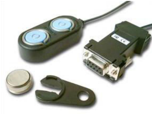
Figure 28 : Ibutton® DS1922L fabriqué par Dallas Semiconductor, USA et son lecteur externe.
