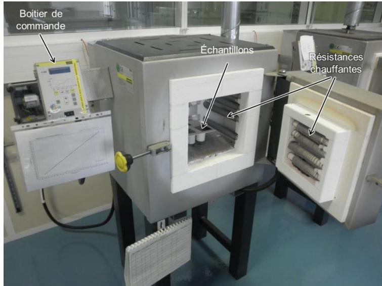
Figure 2.16 Photographie du four Nabertherm utilisé pour les vieillissements à 650°C.
