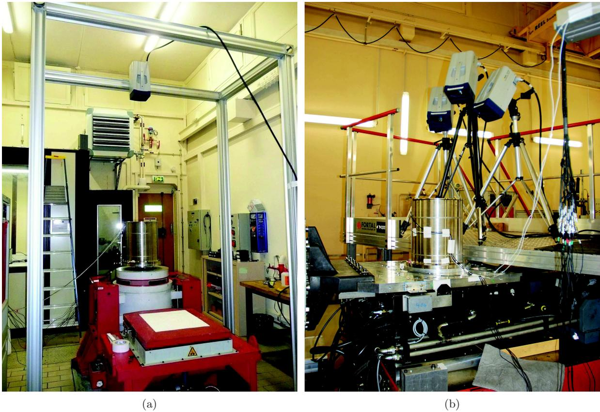
FIG. 3.15: Photographies des montages expérimentaux pour les mesures vibrométriques laser à balayage 1D (a) et 3D (b).
