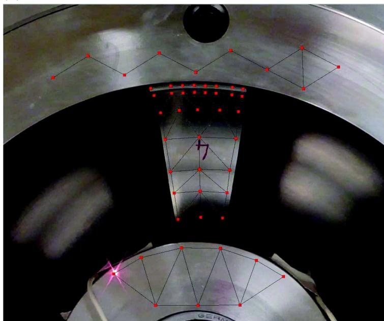
FIG. 3.16: Emplacement des points de mesures pour la vibrométrie laser 1D.
