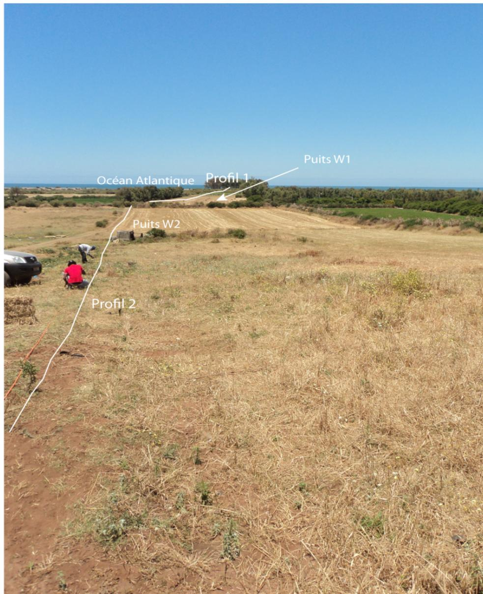
FIGURE D.4 – Photo des deux premiers profils tomographiques avec les puits
