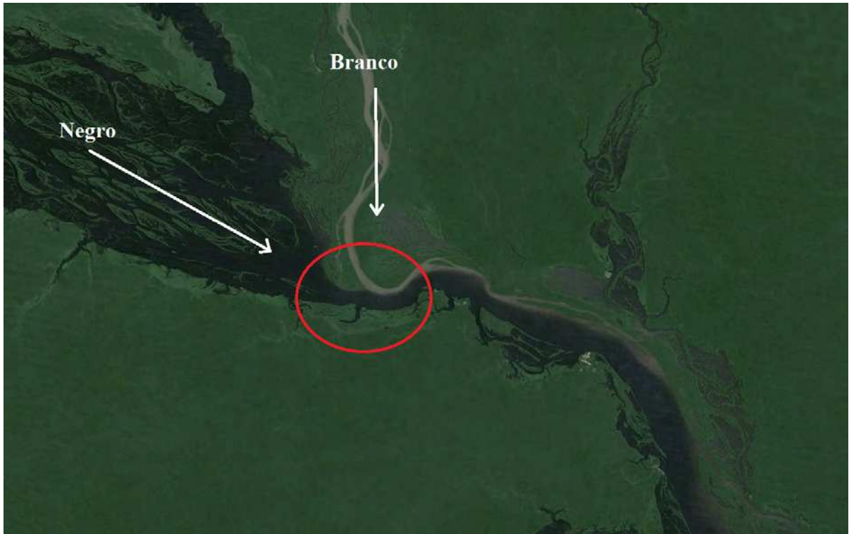
FIGURE 11.3. – Confluence entre le Branco et le Negro montrant l'effet de barrage physique du premier sur le second et le sens des écoulements (Image LandSat)
