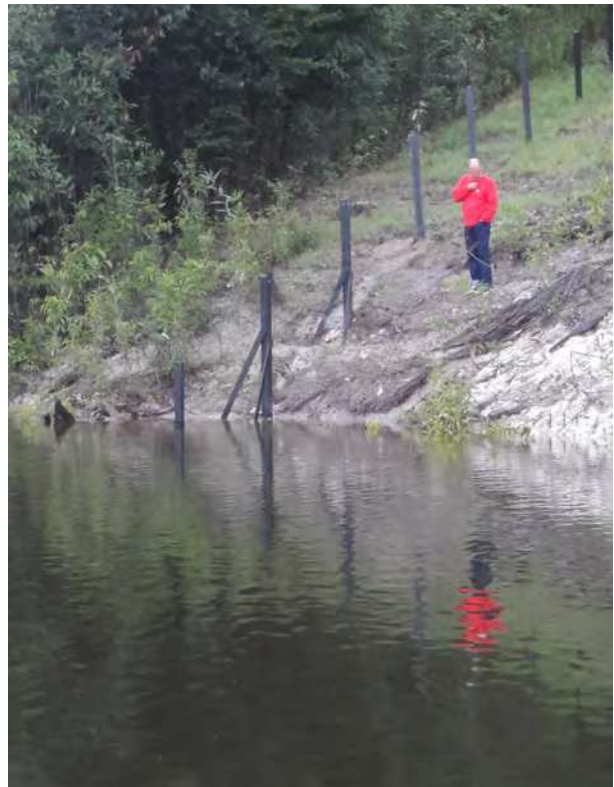
FIGURE 2.12. – Échelles limnimétriques sur les marges du fleuve Cueiras, affluent du Negro (Archives personnelles)
