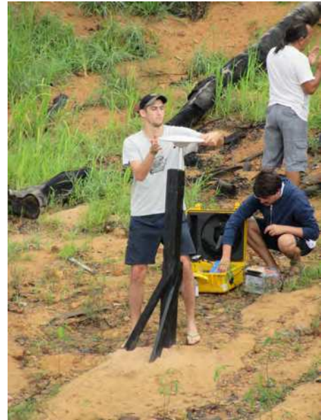
FIGURE 5.1. – Mise en place d'un GPS sur une règle pour son nivellement (Photographie Jacques Veron)
