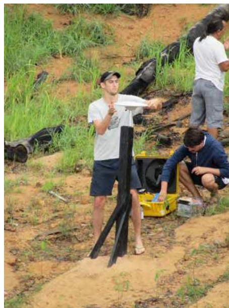
FIGURE 5.1. – Mise en place d'un GPS sur une règle pour son nivellement (Photographie Jacques Veron)
