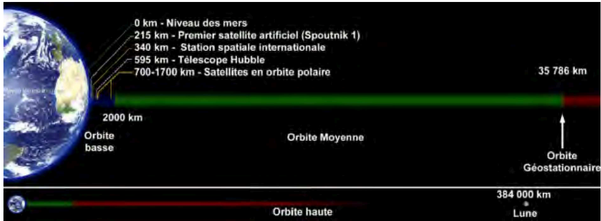
FIGURE 4.8. – Classification des orbites des satellites artificiels par altitude. En bleu les LEO, en vert les MEO, en rouge celles dont l'altitude est supérieure à la GEO (Source : Wikipedia.org)
