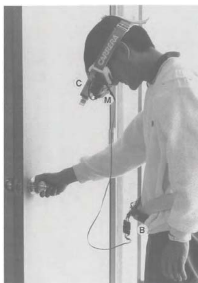
Figure 26 : Simulateur de vision prothétique de Cha. Une caméra couplée à une lentille (C) envoie le signal vidéo directement à un écran qui contient un masque perforé pour simuler la vision phosphénique (M). La caméra et le moniteur sont alimentés par une batterie portée à la ceinture (B). Source [Cha et al. 1992a].
