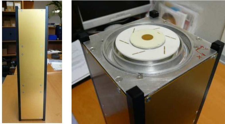
Figure IV-51 :L'antenne à éléments parasites est montée sur la plateforme 3U fabriquée
