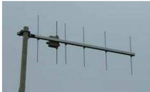
Figure I-1 :L'antenne Yagi-Uda qui équipe l'ensemble de nos foyers pour capter la télédiffusion
