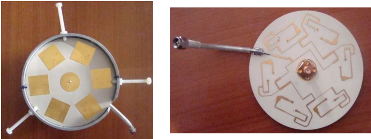
Figure I-32 : Prototype de la structure composée de six patches et d'une fil-plaque mono polaire [81].
