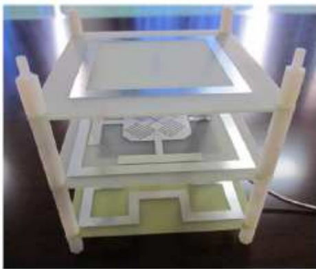
Figure I-12 : Version 2D^{1/2} d'une antenne YAGI compacte à polarisation circulaire pour des applications RFID[28]
