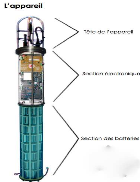
FIGURE 6.7 – Schéma du dispositif d'acquisition AURAL utilisé par l'association Frag-iles.
