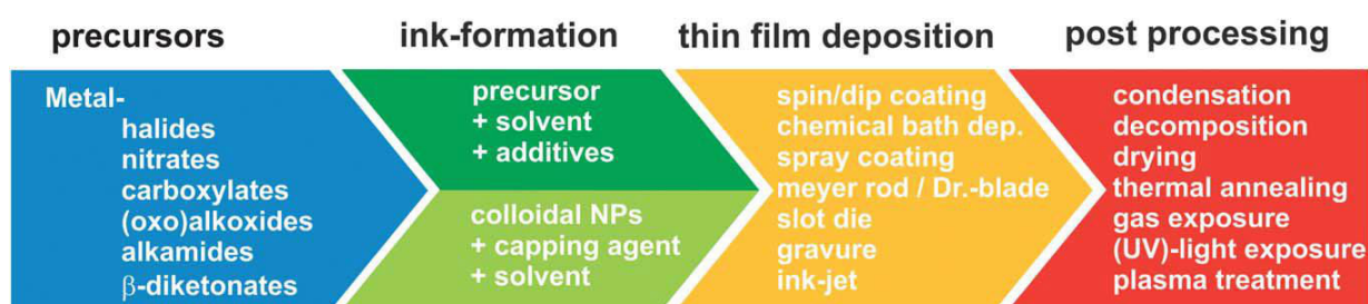
Figure 11. Cheminement classique des dépôts par voie liquide. D'après Zilberberg et al.[47]
