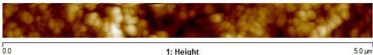
Figure 67. Image AFM de la surface d'un dépôt de nanoparticules de CuSCN
