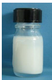
Figure 64. Dispersion de nanoparticules de CuSCN dans l'IPA à 2,5 % en masse
