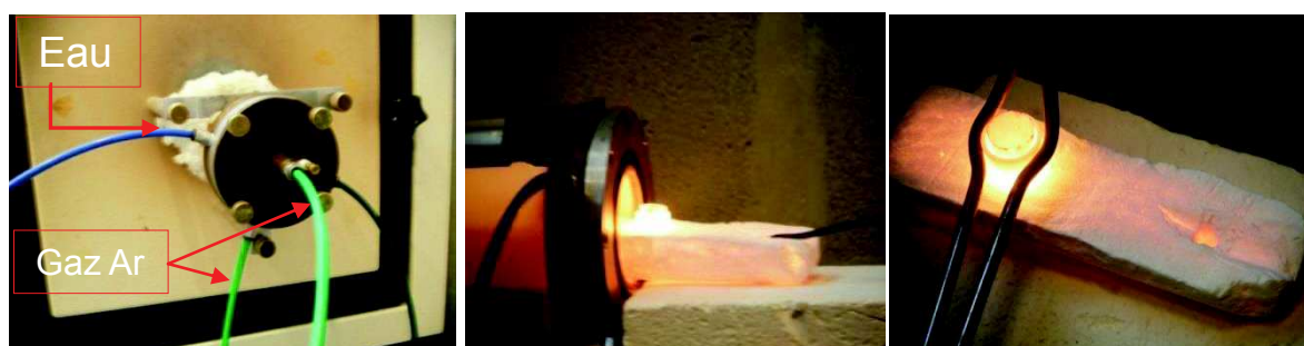
Figure 5. Elaboration d'un échantillon enrichi en ^{17}\text{O} sous atmosphère contrôlée, afin de limiter les échanges avec l'oxygène de l'air, puis sortie à chaud et refroidissement dans le creuset, à l'air.
