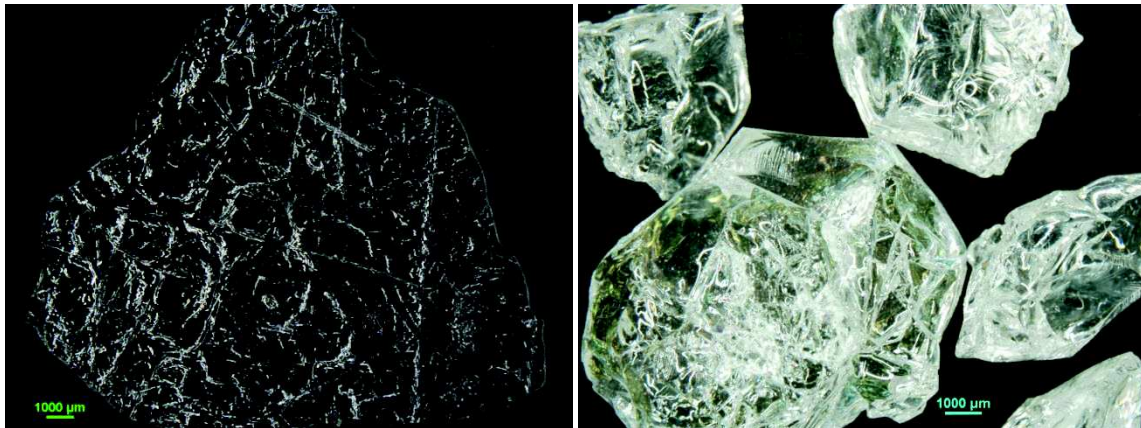
Figure 120. Verre A6, (a) pressé entre deux plaques métalliques et (b) massif, refroidi dans le creuset de platine à la sortie du four sous air
