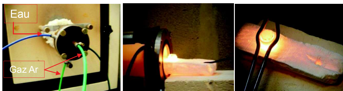
Figure 5. Elaboration d'un échantillon enrichi en 17 O sous atmosphère contrôlée, afin de limiter les échanges avec l'oxygène de l'air, puis sortie à chaud et refroidissement dans le creuset, à l'air.
