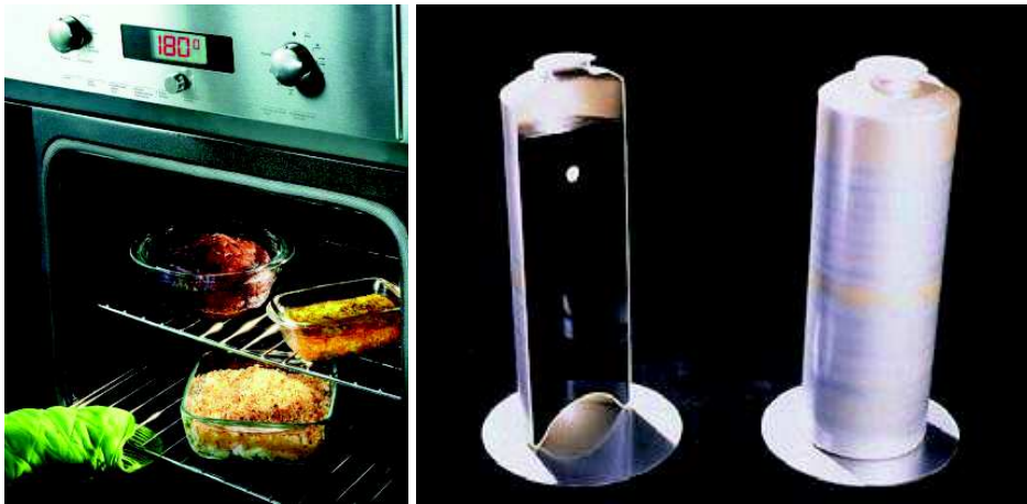
Figure 1. (a) Vaisselle en verre contenant du bore, résistante thermiquement, et (b) verre de confinement pour déchets nucléaires, riche en oxydes de bore et de terres rares.
