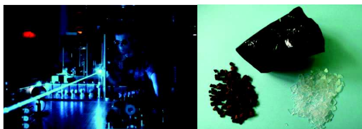
Figure 20. Dispositif LASER (a) et verre de confinement (b), représenté avec le calcinat riche en TR_2O_3 (en bas à gauche) et la fritte de verre riche en B_2O_3 (en bas à droite)
