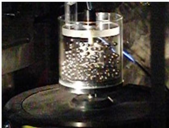
**Figure B.1** – Photo du dispositif expérimental utilisant une cuve transparente afin de visualiser le déplacement des billes dans le gaz granulaire.
