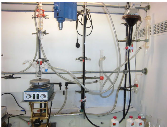
Figure 68 : Montage expérimental du dosage du taux d'hydrazine avec une burette à gaz
