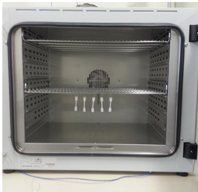
Figure 84 – Une série d'éprouvettes haltères disposées dans une étuve de vieillissement thermique
