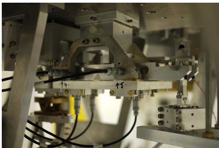
FIGURE 3.8 – Vue photographique du berceau du fléau. Au premier plan à droite est visible le cardan à lames flexibles pincées de la suspension de tare, et on aperçoit au fond à gauche le double cardan.
