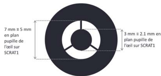
FIGURE 2.3 – Description du diaphragme annulaire permettant de filtrer les réflexions spéculaires sur la cornée au niveau des instruments d'analyse.
