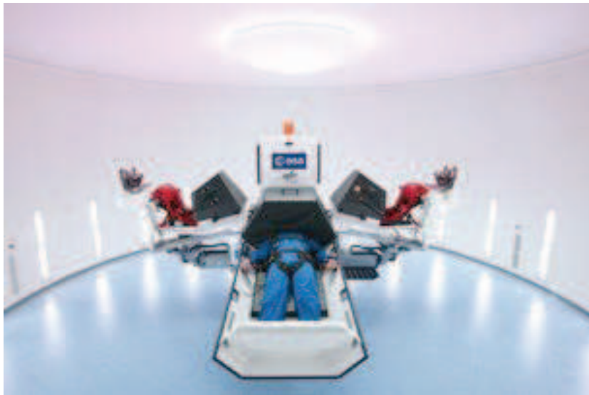
Figure 15 : Gravité artificielle recrée chez l'homme par une centrifugeuse. Crédit photo : ESA.
