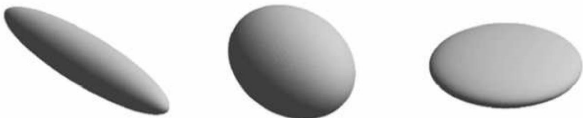
Figure 23 : Forme de l'ellipsoïde en fonction des valeurs propres. Gauche diffusion anisotrope ( \lambda_1 \gg \lambda_2 = \lambda_3 ) forme de cigare, au centre diffusion isotrope ( \lambda_1 = \lambda_2 = \lambda_3 ) forme de sphère, à droite diffusion dans un plan ( \lambda_1 = \lambda_2 \gg \lambda_3 ) forme de galette. D'après (Tournier et al. 2003).
