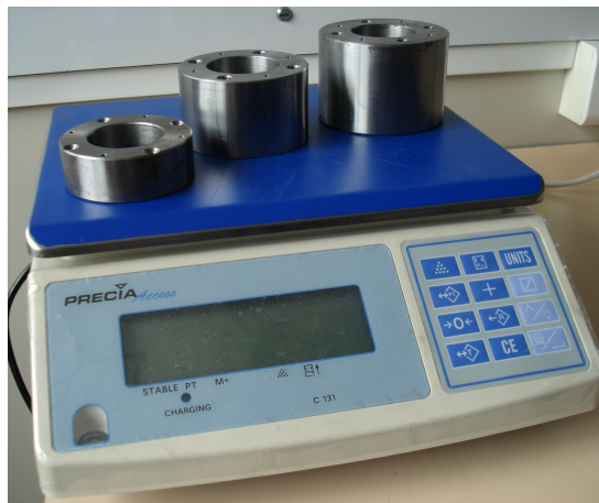
FIGURE 2.24 – Masses additionnelles pour la partie mobile.
