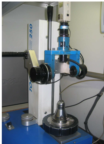
(a) Banc de contrôle optique (caméra et système de positionnement)
