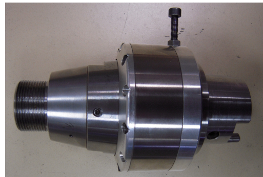
(b) Porte outil à effet vibratoire utilisant ce roulement
