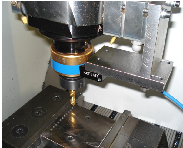
FIGURE 4.15 – Montage de perçage avec le dynamomètre rotatif.
