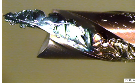
FIGURE 1.8 – Phénomène de bourrage copeau dans la goujure et rupture d'outil à une profondeur L=12xD
