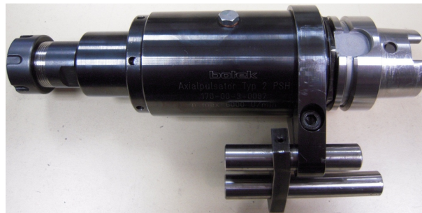
(b) Porte outil à effet vibratoire utilisant ce brevet
