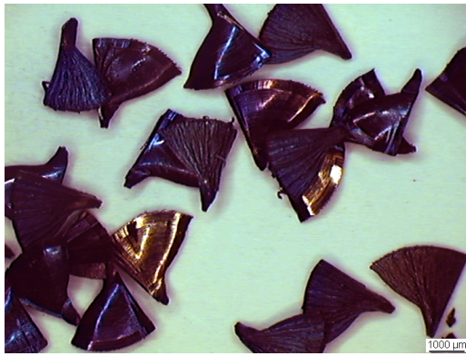
(a) Morphologie des copeaux, 9000tr.min^{-1} , 0,075mm.tr^{-1}
