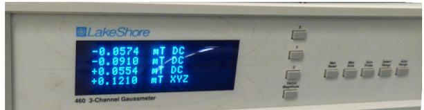
(d) LakeShore Model 460 3-channels Gaussmeter
