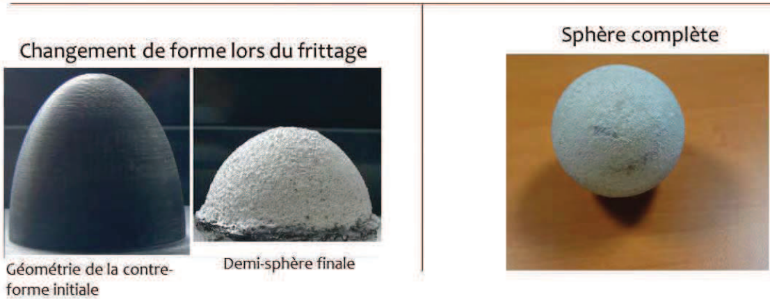
Figure V-29 Photographies du démoulage de la demi-sphère et de la sphère complète.
