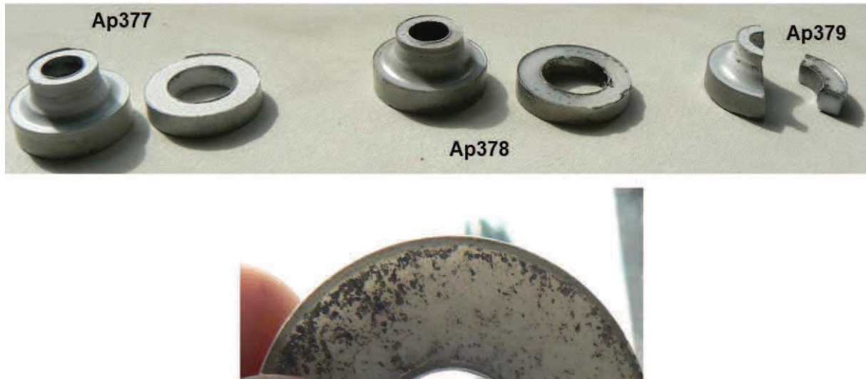
Figure V-26(en haut) Photographie de pièces obtenues pour les trois essais (en bas) mise en évidence de l'aspect translucide de la pièce AP379 à la lumière de soleil.
