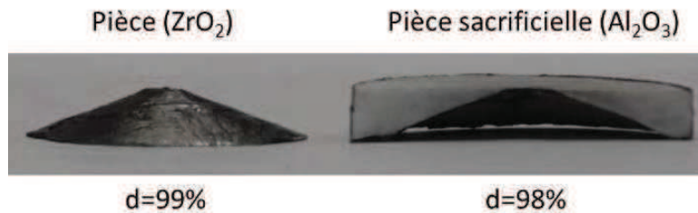
Figure V-33 Pièces obtenues avec la méthode « mobilint » avec deux matériaux.
