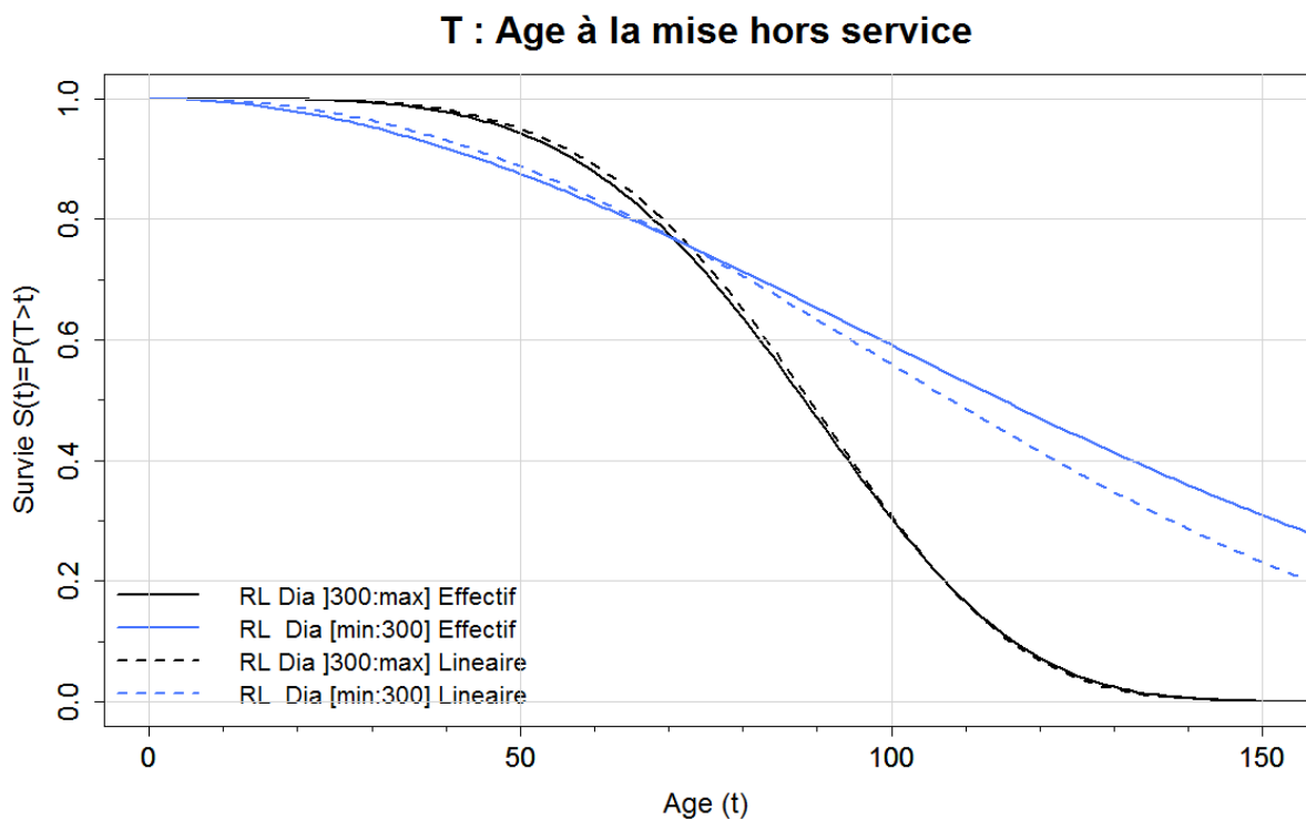
Figure 13 : Comparaison courbes de survie prospective en effectif et en linéaire par classe de diamètres
