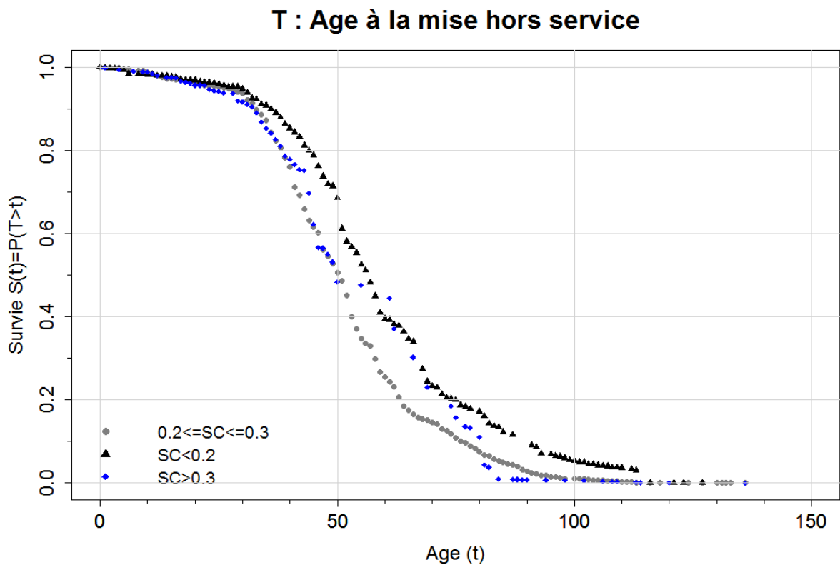
Figure 5 : Courbes de survie passée (Kaplan Meier) en linéaire tronçons par strate de SC
