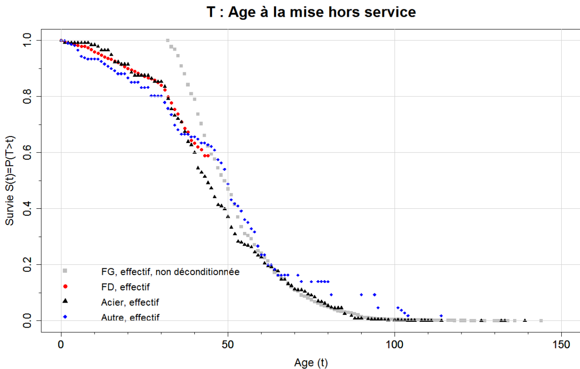
Figure 12 : Courbes de survie passée (Kaplan Meier) en nombre de tronçons par strate de matériau
