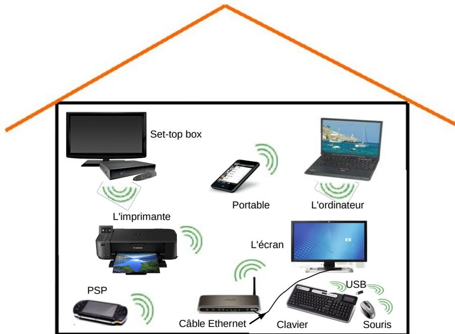
FIGURE 1.1 – Réseau type de communications domestiques
