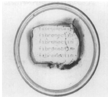
Figure 4 : Première impression biologique par imprimante jet d'encre. Des protéines de fibronectine ont été imprimées sur substrat de plastique [15].
