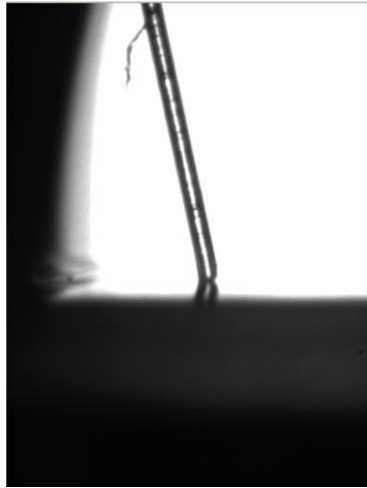
Figure 30 : Vérification de la calibration avec une fibre optique d'épaisseur connue.
