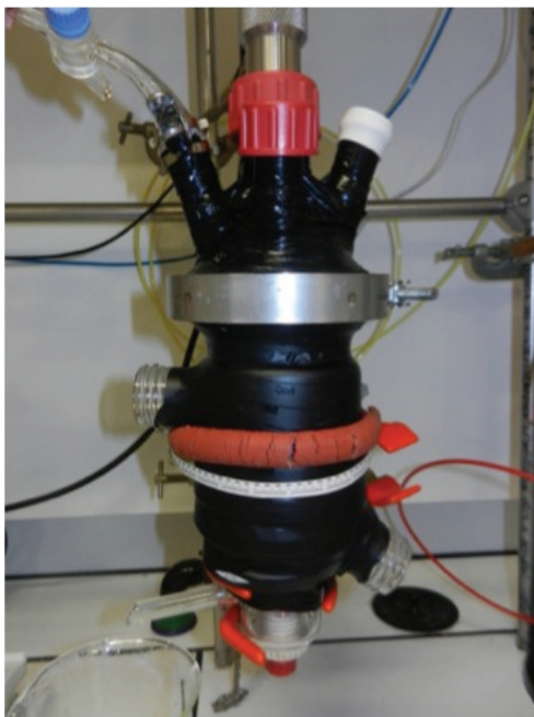
Figure 5.12 : Réacteur de polymérisation en émulsion à double enveloppe équipé d'une guirlande de LED
