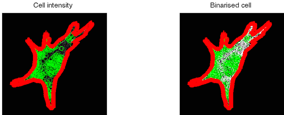
Figure II.5.2.b Capture d'écran montrant la détection des plaques au sein d'une cellule. A gauche, mesure de l'intensité de chaque plaque, à droite calcul de la distance entre la plaque et la membrane grâce à une image binaire.
