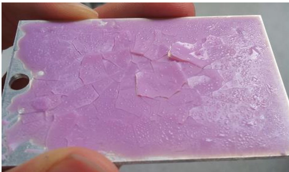
Figure IV.2 : aspect d'un film composite déposé sur une plaque d'aluminium et exposé 24 heures à des vapeurs de TEOS.
