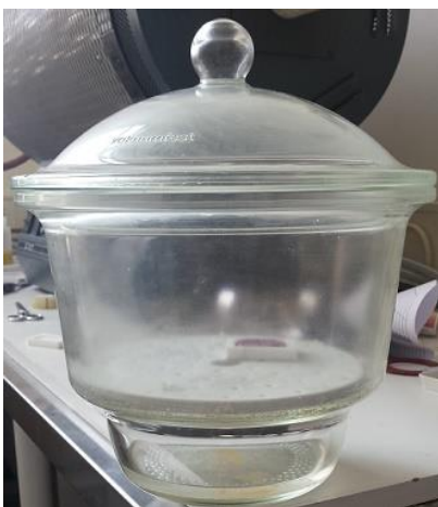
Figure IV.5 : composite coulé dans un moule en PTFE et placé dans un dessiccateur saturé de MTEOS
