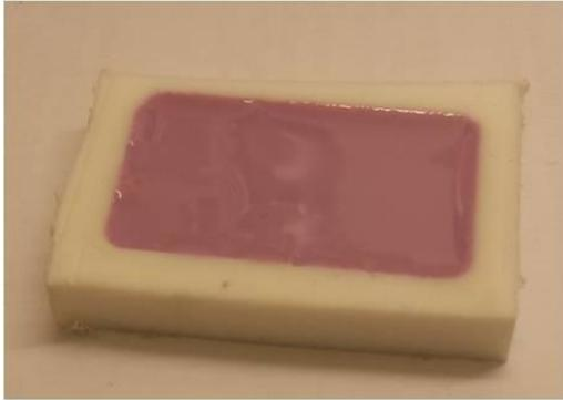
Figure IV.4 : moule en PTFE rempli d'un gel composite mature
