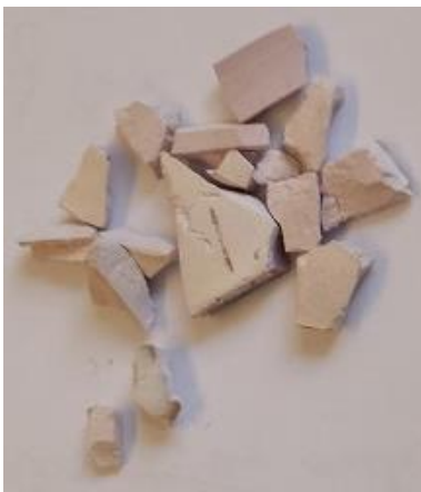
Figure IV.11 : aspect d'un composite exposé pendant une semaine aux vapeurs de MTEOS après 50 jours laissé à l'air libre
