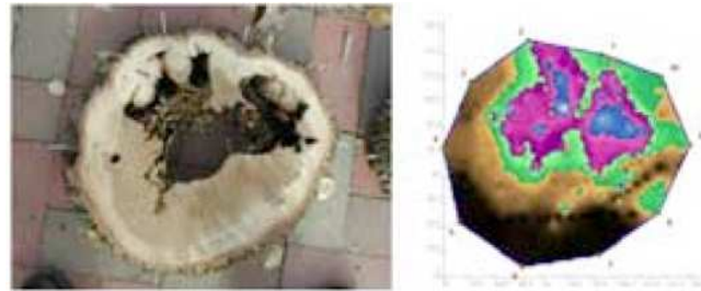
(b) reconstruction de l'intérieur d'un arbre par tomographie ultrasonore
