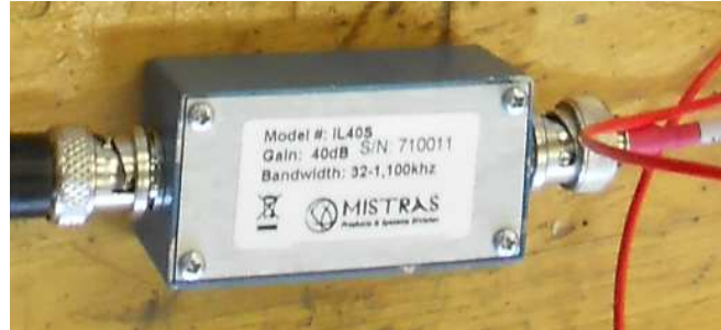
FIGURE B6: Cliché d'un préamplificateur et du câble coaxial
