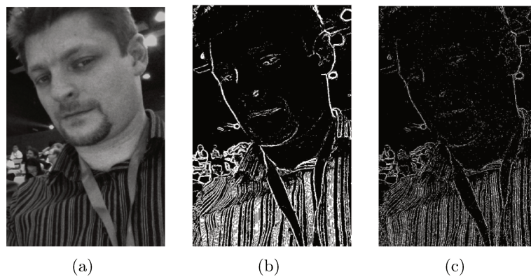
FIGURE 2.15: Applications de la détection de contour à un visage, a) Image originale, b) Détection de contour par le filtre Sobel, c) Détection de contour par le filtre laplacien
