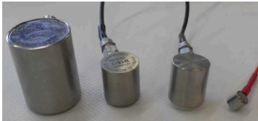
FIGURE 2.24: Modèles de transducteurs disponibles
