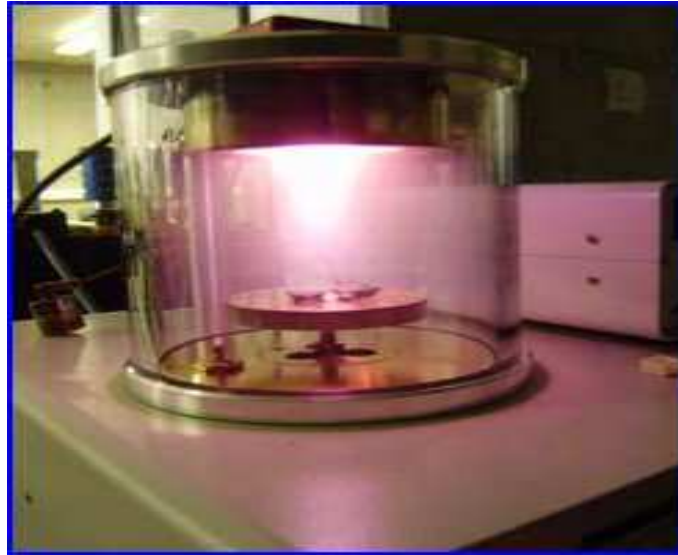
Figure II.13 : Métallisation par pulvérisation cathodique d'un échantillon
