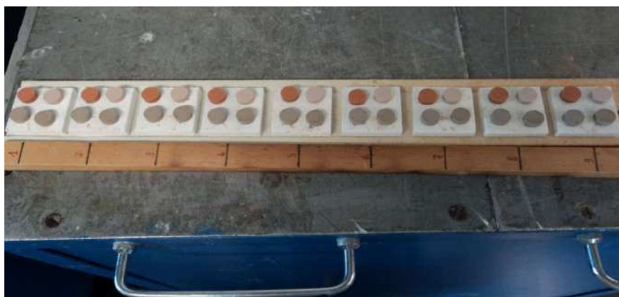
Figure IV.1 : Pastilles d'argile placées sur une plaque selon les neuf zones fonctionnelles du four gradient
