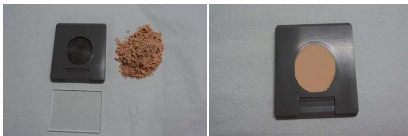
Figure II.9 : Préparation d'un échantillon d'argile pour la DRX.
