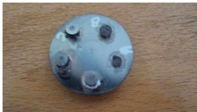
Figure II.14 : Échantillons démoulés de la résine et posés sur un porte-échantillon.
